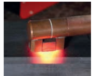
▶ Erwärmen eines Bauteils mit der Fokusspule seitlich
