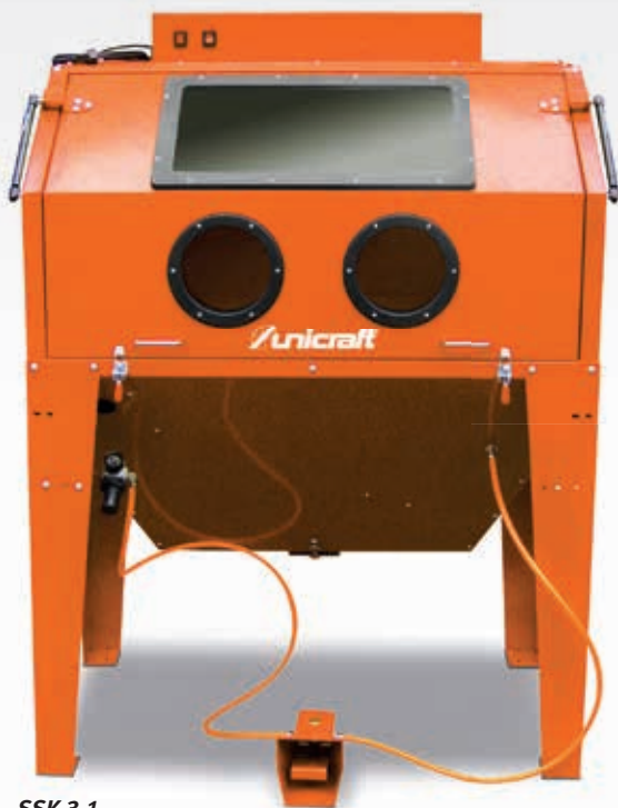
Abb. zeigt SSK 3.1 mit sehr großer, nach oben öffnender Frontklappe
