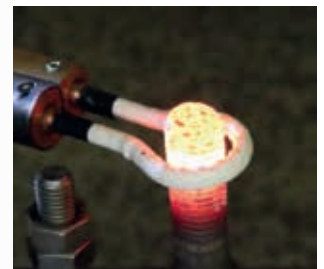
▶ Erwärmen eines Gewindebolzens mit der wassergekühlten Spule
