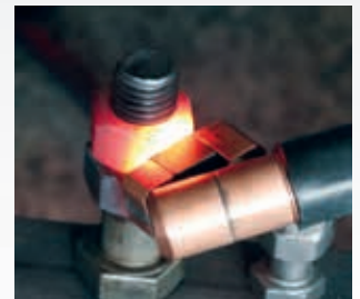
▶ Erwärmen einer Mutter mit der Fokusspule schräg
