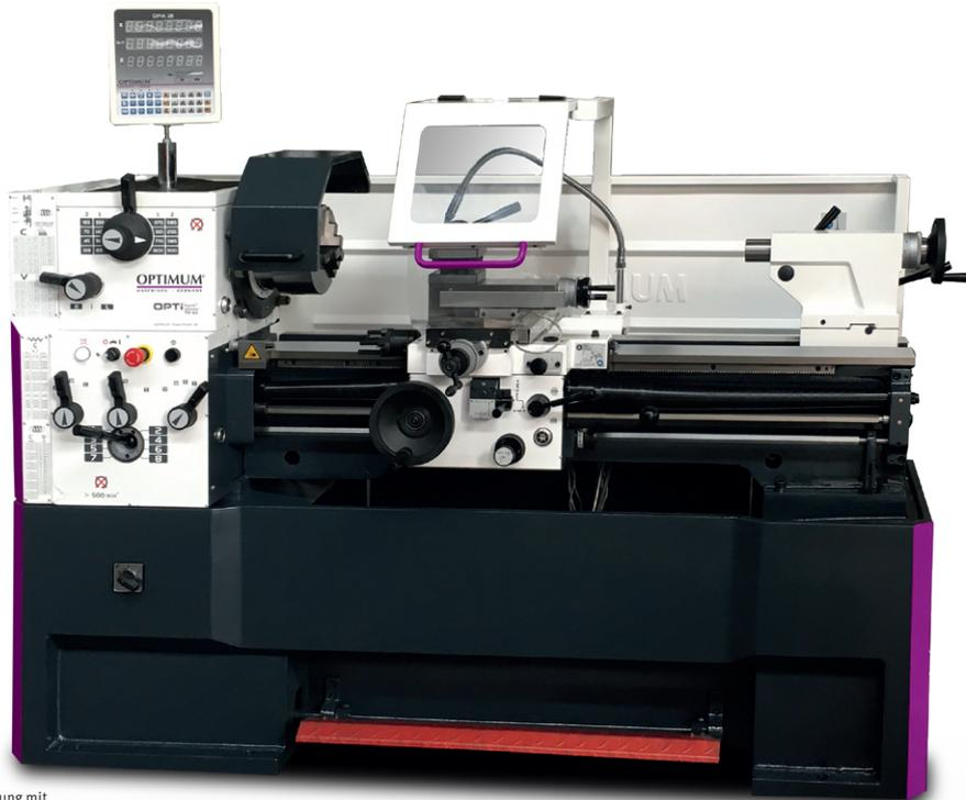
Abb.: TH 4210D - Abbildung mit optionalem Drehfutter
