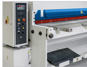
▶ Bedienpult an der linken Maschinenseite
