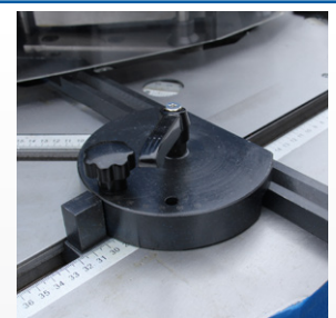
▶ Exakte Winkeleinstellung mithilfe von Anschlägen und Skalen
