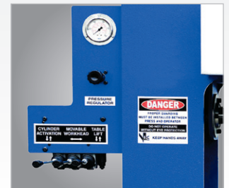
▶ Druckempfindliche Handhebel und Druckmanometer
