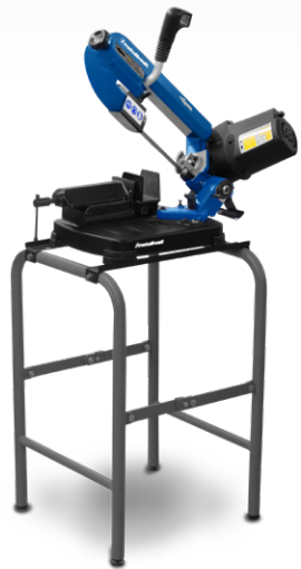
Abb. zeigt MBS 105 auf Maschinenuntergestell MUG 1 : Tragekapazität bis zu 100 kg, passend für MBS 105, MBS 125, MBS 150, MTS 356
