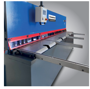
▶ Kugeln im Auflagetisch für besseres Blech-Handling ▶ Seitenanschlag 1500mm mit Skala und T-Nut
