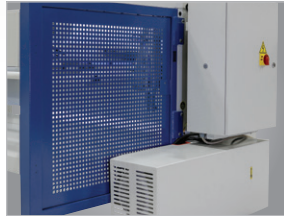
▶ Rückraumsicherung nach CE mit Seitenblechen und Lichtschanke
