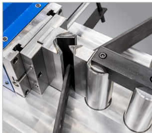
▶ Mit Schnellwechselaufnahme und Seitenanschlag mit Skala
