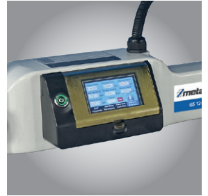
▶ Einstellung der Parameter über im Schwenkarm integrierten Touchscreen
