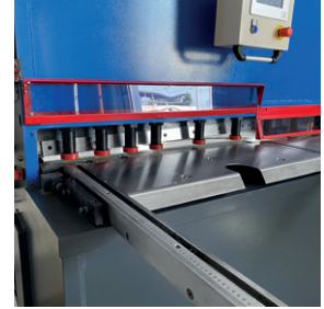
▶ Hochklappbarer Fingerschutz 1000 mm mit Sichtscheibe
