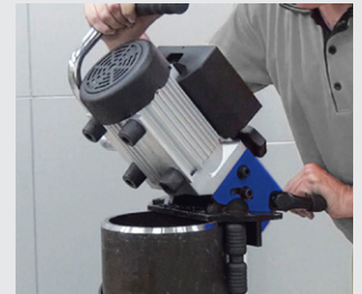
Entgraten von Rohren möglich
