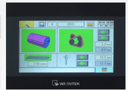
▶ Bedienung der Maschinenfunktionen über 8" Touchscreen
