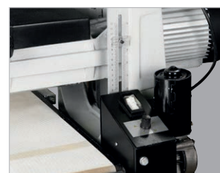
Höhenverstellung der Schleifeinheit an einer Skala ablesbar
