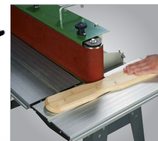
Einfachstes Schleifen von Radien
