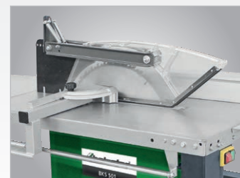
Pendel-Sicherheits-Schutzhaube ▶ Transparente Schutzhaube zur Sicherheit des Anwenders und für optimale Sicht auf die Schnittlinie
