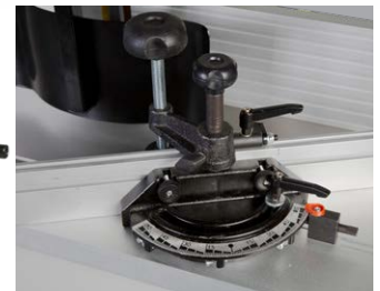
Stufenlos verstellbarer Winkelanschlag
