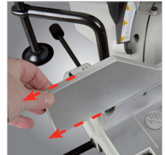
Ausziehbare Anschlagsschienen und ausziehbarer Tisch
