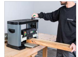
Höheneinstellung über Handkurbel und Skala
