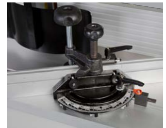
Stufenlos verstellbarer Winkelschlag
