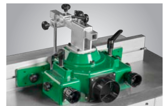
Fräsanschlag mit fein einstellbaren Aluminium-Anschlägen
