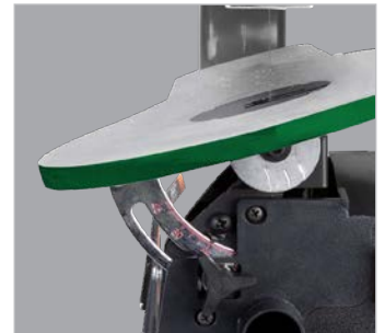
Tischwinkel über Skala genau einstellbar
