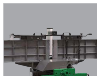
Schnelles Umrüsten ▶ Gleichzeitiges Hochklappen der Abrichttische mit Federunterstützung ▶ Schnelles und bequemes Umrüsten in Sekunden
