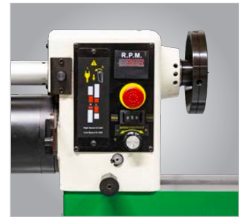
Digitalanzeige für Drehzahl integriert
