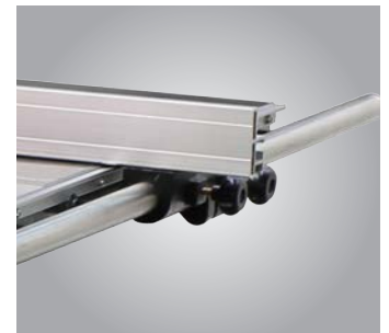
Großer Aluminium-Parallelanschlag auf Rundstangenführung mit Feineinstellung
