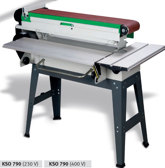
Mit Quertisch zum Konturschleifen, schwenkbar bis 45°
