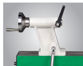
Reitstock schnell und einfach über Klemmhebel fixierbar und Pinole leicht über Handrad verstellbar
