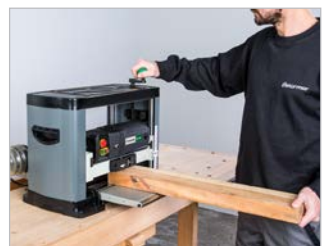
Höheneinstellung über Handkurbel und Skala
