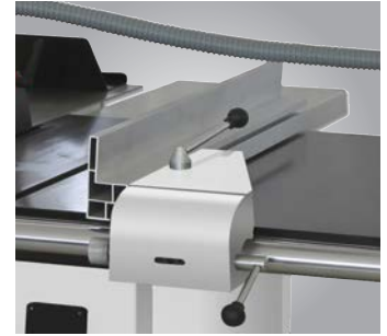
Großer Aluminium-Parallelanschlag auf Rundstangenführung mit Feineinstellung
