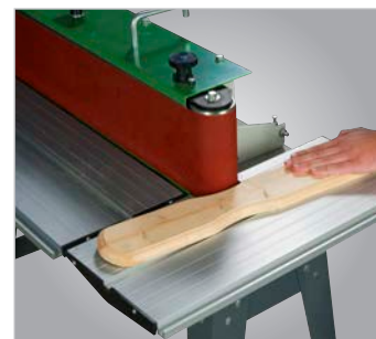
Einfachstes Schleifen von Radien
