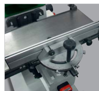
Winkelanschlag beidseitig um 60° verstellbar
