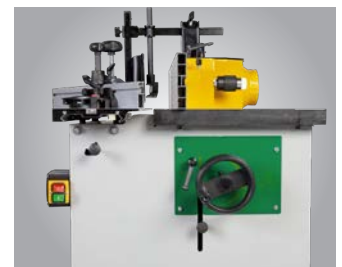
Handrad für Höhenverstellung. Sicherheitsvorrichtungen im Lieferumfang
