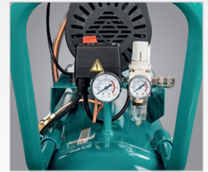
· Ausgestattet mit Condor MDR 1 Druckschalter
