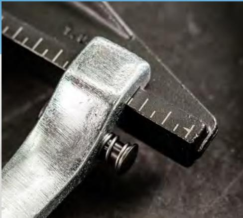
„Gesenkgeschmiedete Bauteile kündigen eine mögliche Überbelastung durch Verbiegen an, da der beim Schmieden entstehende Faserverlauf des Materials eine gewisse Flexibilität der Bauteile zulässt, bevor es zu einem Bruch kommt - eine sehr „gesunde“ Eigenschaft.“
