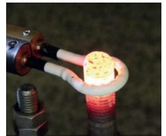
▶ Erwärmen eines Gewindebolzens mit der wassergekühlten Spule
