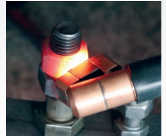
▶ Erwärmen einer Mutter mit der Fokussierungsspule schräg
