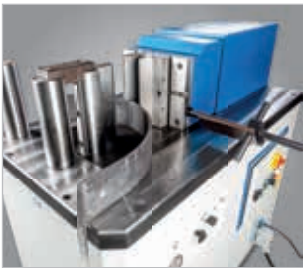
▶ Mit Schnellwechselaufnahme und Seitenanschlag mit Skala
