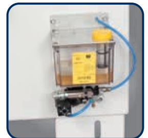
▶ Mikrodosierungseinrichtung direkt am Sägeblatt
