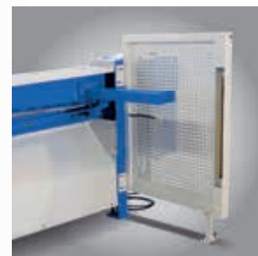
▶ Rückraum durch Lichtvorhang abgesichert
