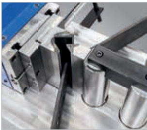
▶ Mit Schnellwechselaufnahme und Seitenanschlag mit Skala
