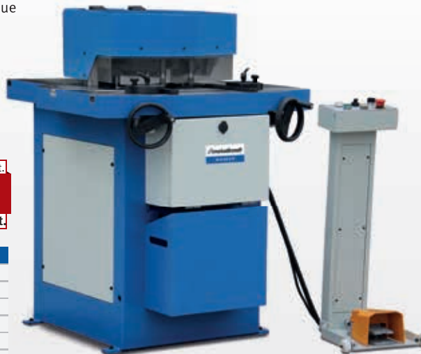
▶ Exakte Winkeleinstellung mithilfe von Anschlägen und Skalen
