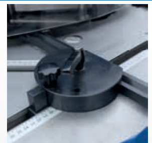
▶ Exakte Winkeleinstellung mithilfe von Anschlägen und Skalen
