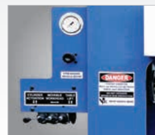
▶ Druckempfindliche Handhebel und Druckmanometer
