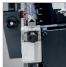
▶ CNC-gesteuerte, motorische Bombierung
