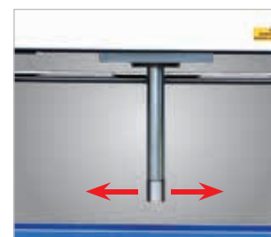
▶ Seitlich verfahrbarer Hydraulikzylinder
