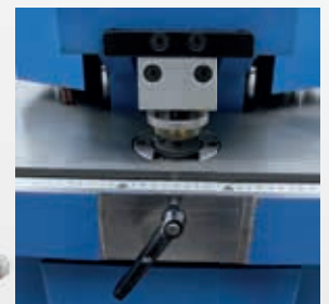
▶ Stanzstation mit 12 Tonnen Stanzdruck an der Rückseite
