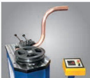
▶ Biegewinkel bis 180° möglich
