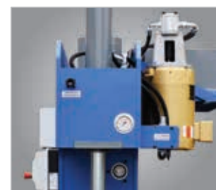
▶ Seitliche Räumpresse mit Druckmanometer
