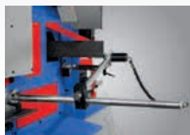
▶ Elektrischer Kontaktanschlag (serienmäßig ab HPS 55DS)
