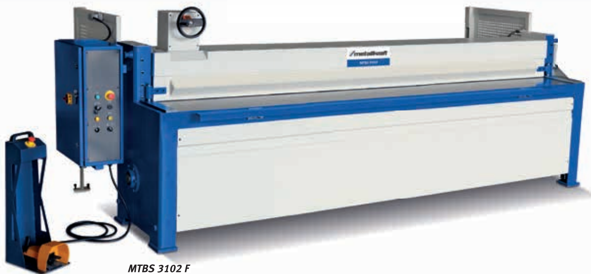
▶ Rückraum durch Lichtvorhang abgesichert
