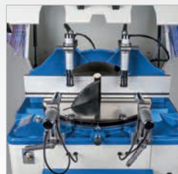
Serienmäßig mit vier pneumatischen Spannzylindern
