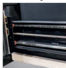
▶ Die über Kugelumlaufspindeln angetriebene X-Achse läuft auf doppelter Linearführung
