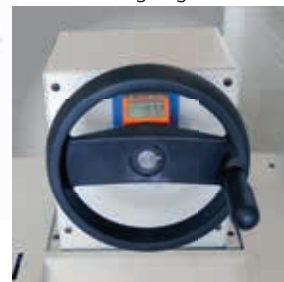
MTBS 2103 F ▶ Bedienung des Hinteranschlags von der Maschinenfront über Handrad und Zählwerk
