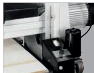
Höhenverstellung der Schleifeinheit an einer Skala ablesbar
