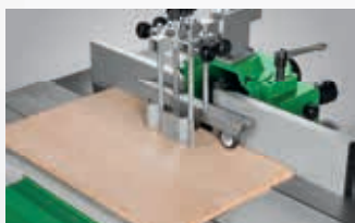
Fräsanschlag mit feineinstellbaren Aluminium-Anschlägen
