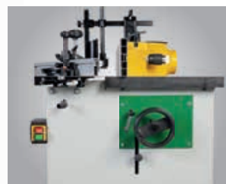
Handrad für Höhenverstellung. Sicherheitsvorrichtungen im Lieferumfang
