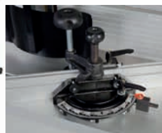
Stufenlos verstellbarer Winkelanschlag
