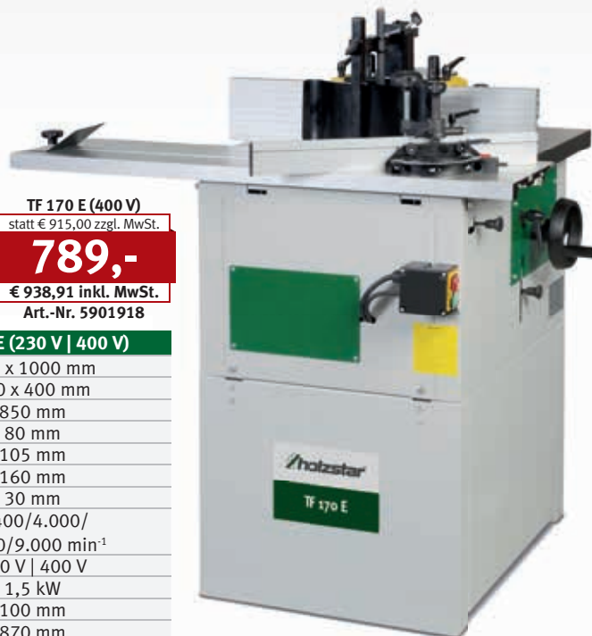
Frässpindel mit 80 mm Nutzlänge und 30 mm Durchmesser
