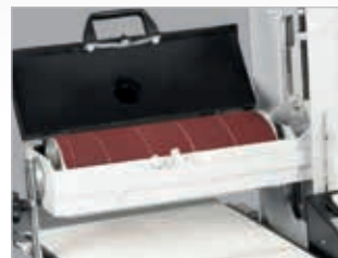
Einfacher und schneller Schleifbandwechsel
