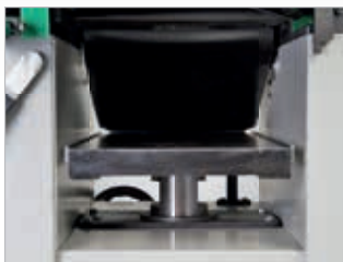
Dickentischverstellung über Handrad, Skala und numerischer Anzeige
