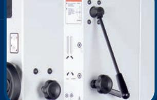
· Sägebandschnellspannung über Exzenterhebel auf Maschinenrückseite
