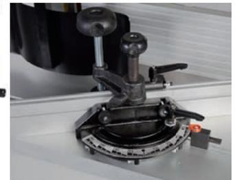
Stufenlos verstellbarer Winkelanschlag
