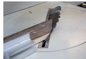
▶ Sägeblattschwenkung bis 45°
