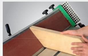
Durch das stufenlos schrägverstellbare Schleifaggregat ist die Kantenschleifmaschine für verschiedenste Schleifvorgänge wie z. B. vertikales und horizontales Schleifen verwendbar
