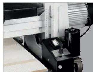
Höhenverstellung der Schleifeinheit an einer Skala ablesbar
